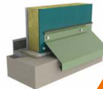
Монтаж стены на цоколе
